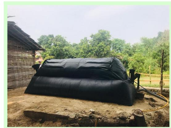
O biodigestor necessita de uma área plana de 10 m<sup>2</sup>, armazena 2.500 L de biogás e pode ser instalado até 50 m de distância do fogão de duas bocas, que acompanha o equipamento. A instalação não demanda infraestrutura civil ou elétrica, assim como o manejo e a manutenção demandam conhecimentos simples, o que os tornam acessível aos usuários.
