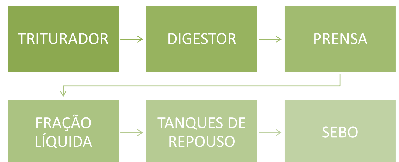
Esquema 2 - Processamento dos resíduos para fabricação de sebo
